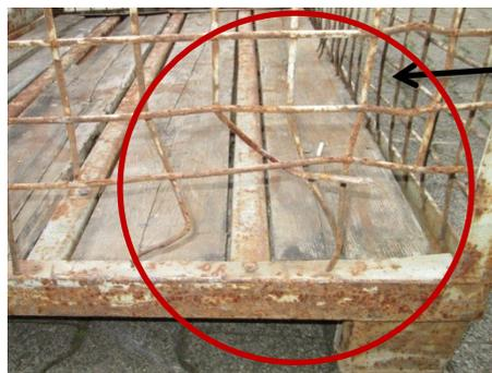
Gitterstäbe sind herausgebrochen oder fehlen. Ein einzelner Stab pro Seite darf einen Mangel aufweisen
